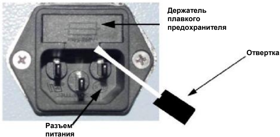
Рисунок 1-6. Извлечение держателя плавкого предохранителя.
