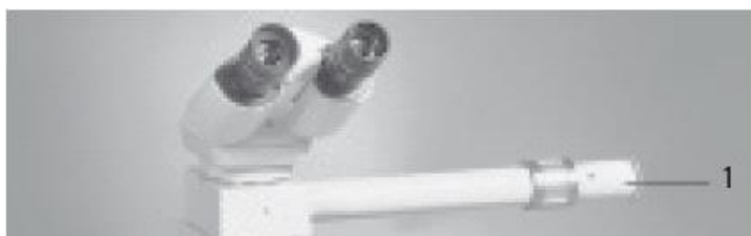
Рис. 37. Устройство для рисования: 1 – заслонка
