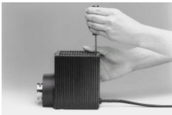
Рис. 14. Общий вид осветителя и способ открытия корпуса
