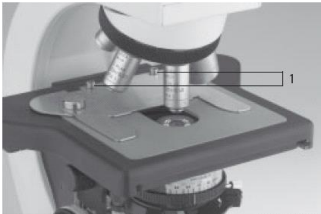
Рис. 9. Предметный столик. 1 – винты крепления препаратодителя
