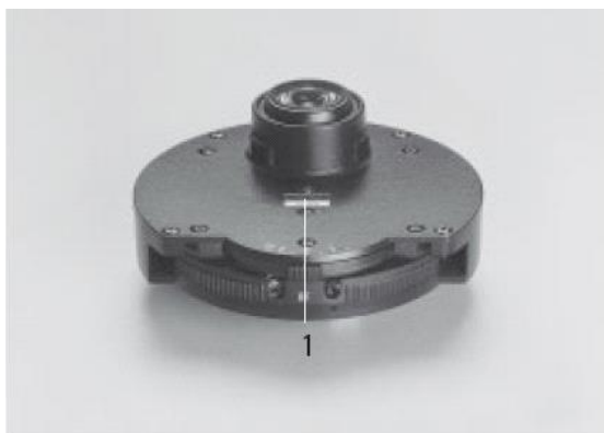
Рис. 2. Конденсор UCL 0.90/1.25 OIL (конденсор UCLP 0.85, необходимый для поляризации света, внешне выглядит также, но не предназначен для масляной иммерсии (гравировка P 0.85):
