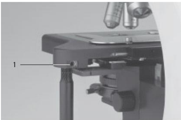
Рис. 10. Предметный столик. 1 – разъем для зажима ручки перемещения столика
