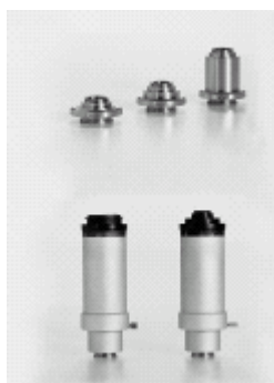
Рис. 34. Адаптеры C-mount для подключения камер к микроскопу:
