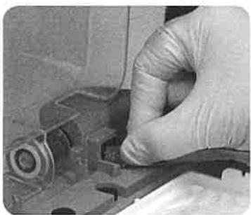
Fig. 25. Connect (-) electrode.
