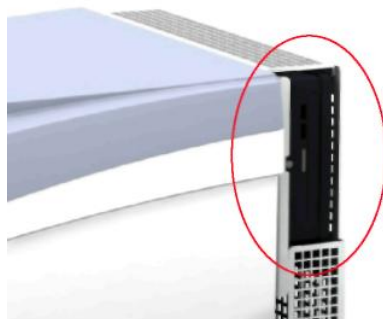
Рисунок 2.1. Местонахождение встроенного ПК
