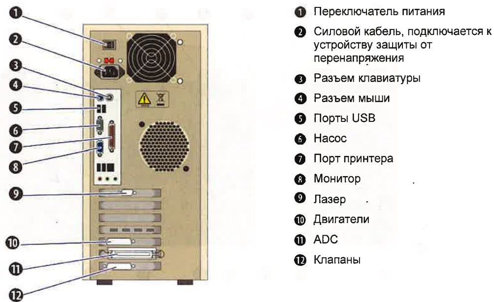
Рисунок 1.15 Подсоединение кабелей к задней части компьютера
