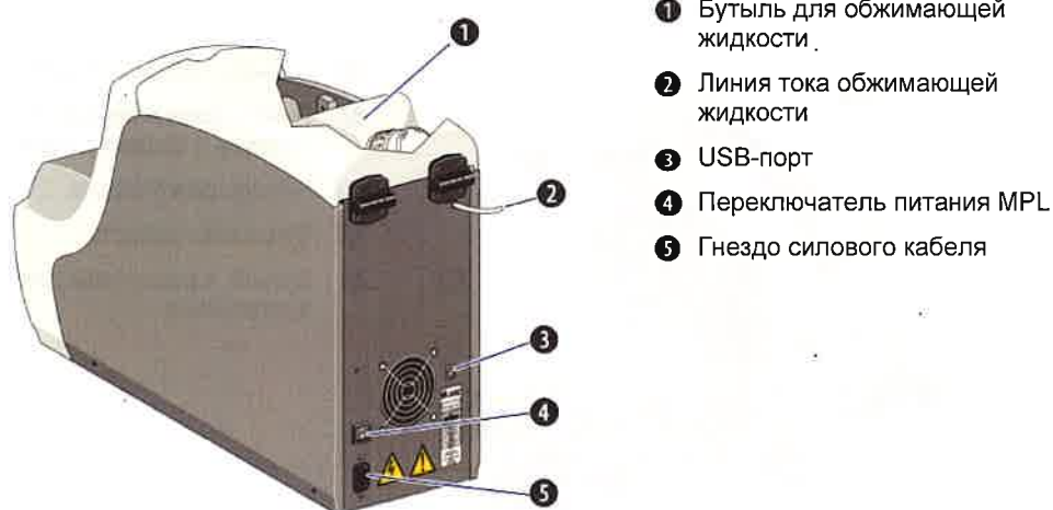
Рисунок 1.12 Средства управления и индикаторы MPL
