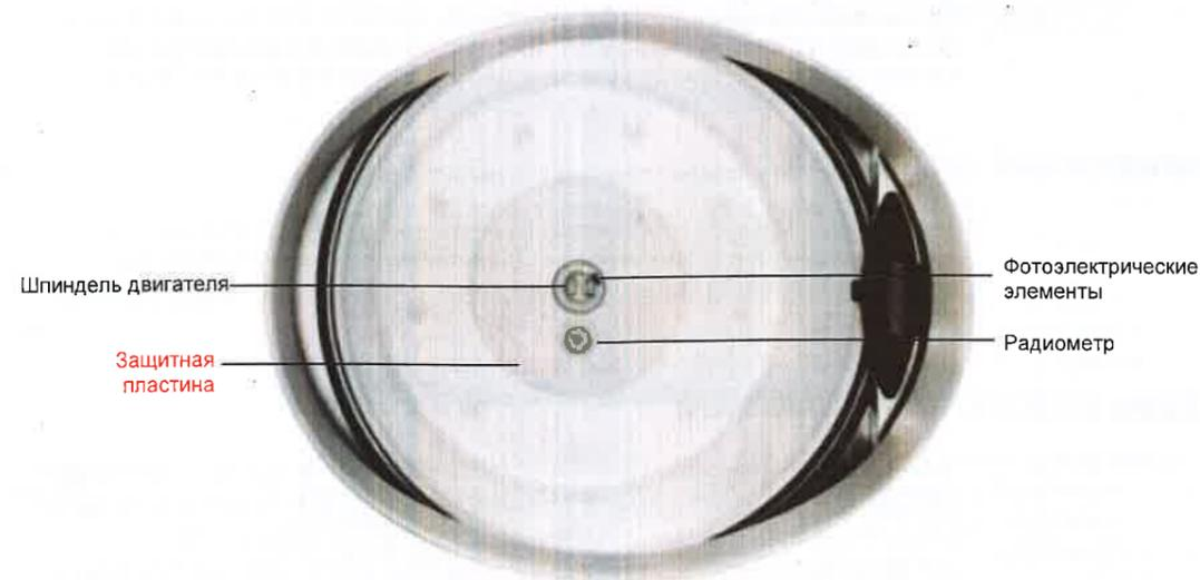
Рисунок 1-2. Внутренняя часть центрифужной камеры
